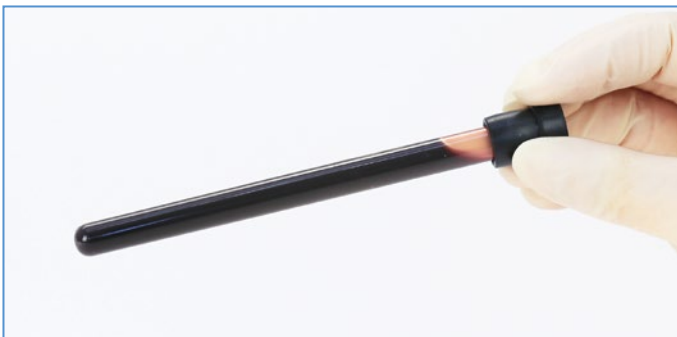
Abb. 20: „Wandernde Luftblase“ als Mischungsindikator
