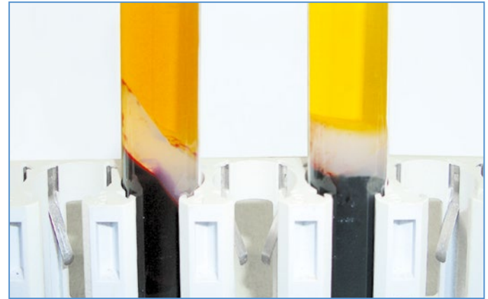
Abb. 27: Links: Trenngelröhrchen in Winkelkopfzentrifuge zentrifugiert, Rechts: Trenngelröhrchen in Ausschwingzentrifuge zentrifugiert.
