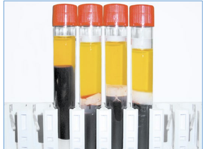
Abb. 25: Falsch zentrifugierte Trenngelröhrchen; Zentrifugengeschwindigkeit wurde nicht eingehalten. Von links nach rechts ansteigende G-Zahl, rechts korrekt zentrifugiertes Trenngelröhrchen.
